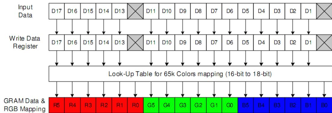
我们一般采取 16 位控制方式 (5-6-5)。在该模式下，我们发现输入 18 位 (D17-D0)，D0 和 D12 这两个位是无效的位。实际上只有 D11-D1，D17-D13 是有效的。也正是这 16 位，最终被送到 GRAM 中显示出某一个颜色的像素点出来。
