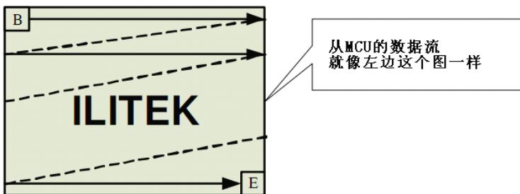
数据是按照上面这个图所示的顺序写入的。在物理存储器里的计数器，决定了数据写入是通过“存储器数据访问控制”指令 MADCTL 的 B5, B6 位来控制，如下面所示：
